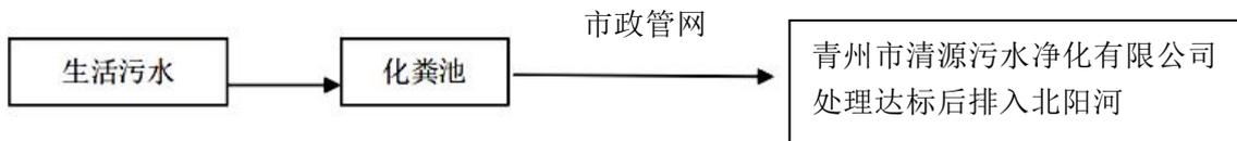
图 3.1-1 项目废水处理流程图
