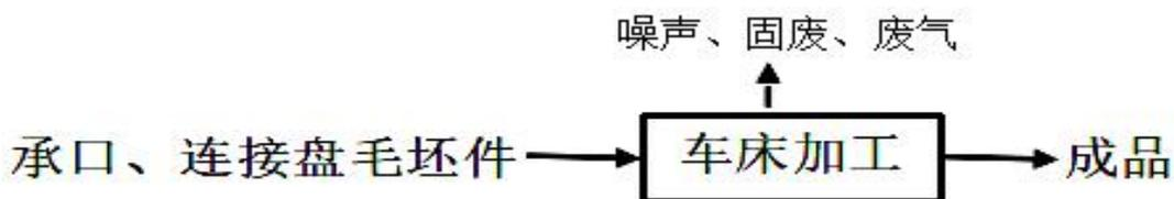
图 2.3-1 (3) 承口、连接盘生产工艺流程图
