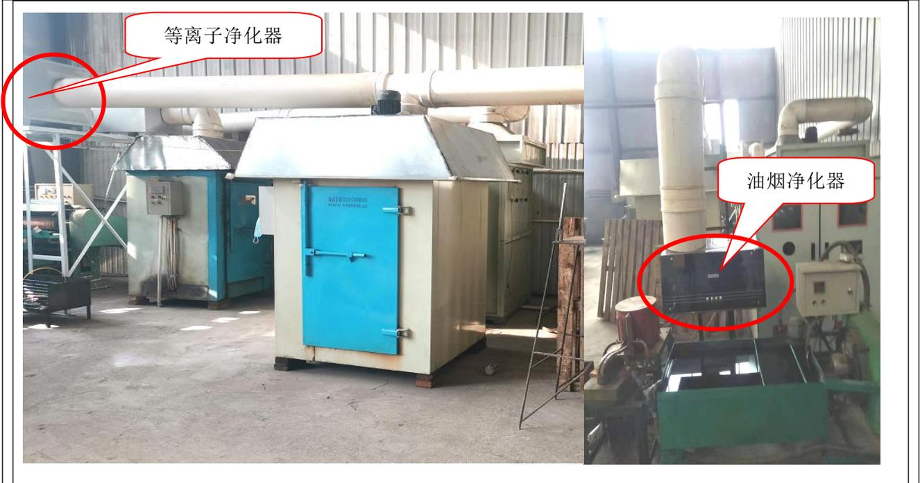
高频电加热机废气处理设备
