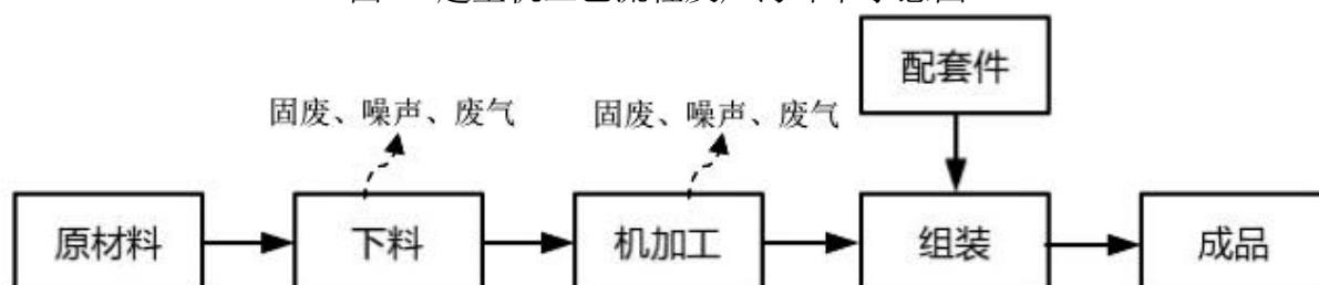
图一 起重机工艺流程及产污环节示意图
