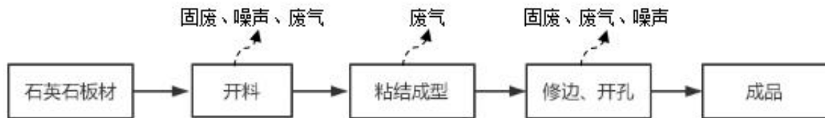
图一 整体厨房台面工艺流程及产污环节示意图
