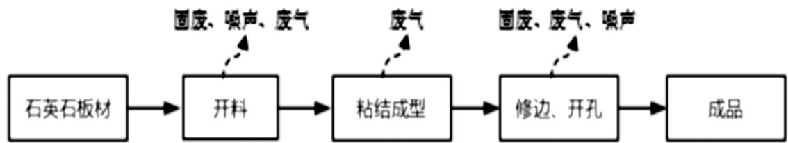
图 2.3-1 整体厨房台面工艺流程及产污环节示意图
