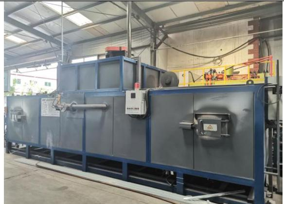
挤压机+铝棒加热炉（天然气）
