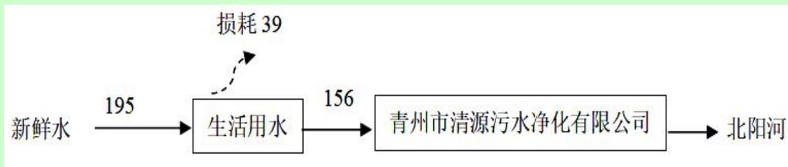
图1 项目水平衡图 单位：m<sup>3</sup>/a
