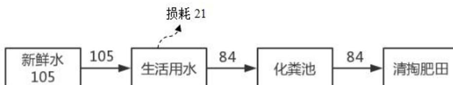
图 2.2-1 项目水量平衡图 单位：t/a
