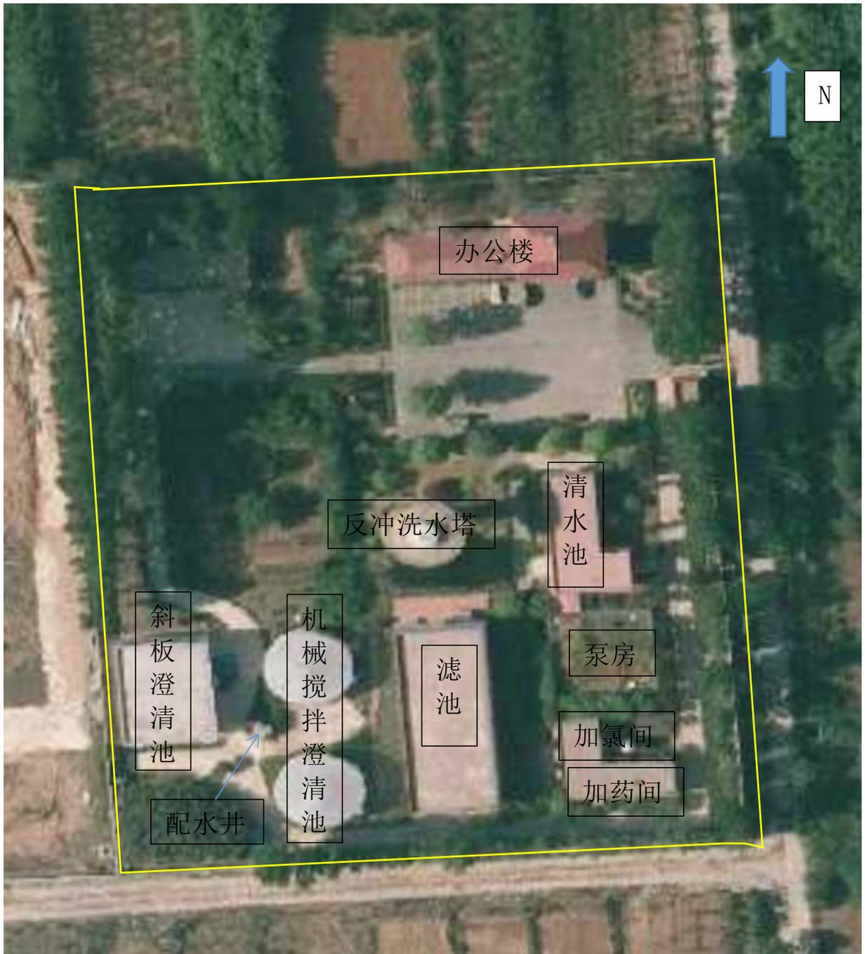
图 2 三水厂平面布置图 比例尺 1:2252
