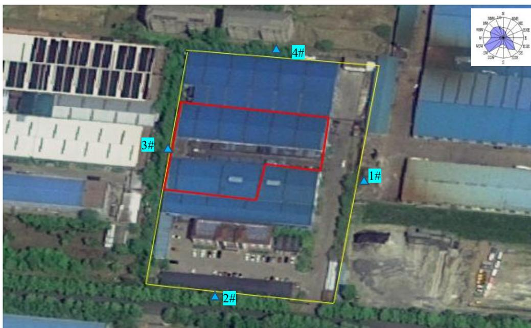
**图 6-1 噪声监测点位布局图**
